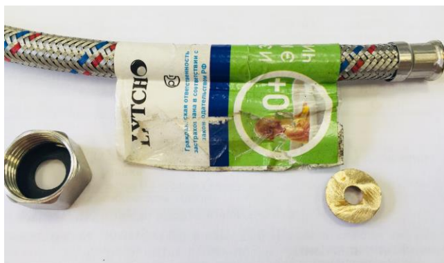
Рис. 1 Образец №1 0505.695 Гибкая подводка "Lytcho" для воды в стальной оплетке, Г/Г, 300 мм
